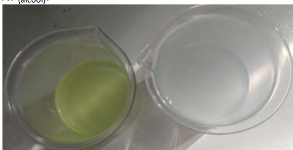
Figura 6. Solução de amarelo tartrazina antes e após o tratamento fotocatalítico com ZnO-NP (álcool) .
