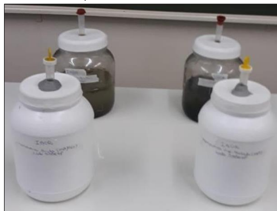
Figura 3. Reatores com os efluentes (manipueiras bruta e pré-tratada) e os inóculos (lodo aeróbio e lodo anaeróbio).
